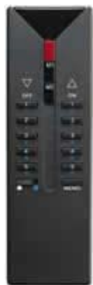
Infračervené dálkové ovládání pro řízení osvětlení v konferenčních a jednacích sálech
